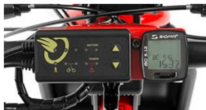
Ένδειξη μπαταρίας, ρύθμιση ταχύτητας, LCD οθόνη.
