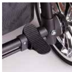
Φρένο συνοδού χειριζόμενο με το πόδι.
