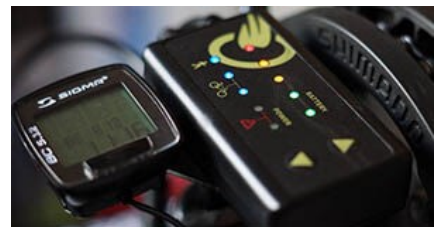
Ένδειξη μπαταρίας, ρύθμιση ταχύτητας, LCD οθόνη.
