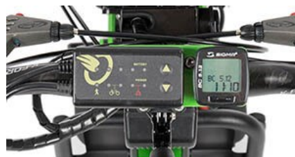
Ένδειξη μπαταρίας, ρύθμιση ταχύτητας, LCD οθόνη.
